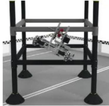
图 10 机器人仍接触第一条高塔横杆，因此，它处于第一层攀爬
