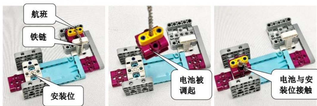
图示 8：电池吊装模型的初始、中间及完成状态
