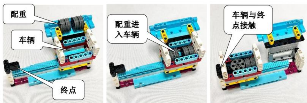
图 9 载重测试模型的初始、中间及完成状态
