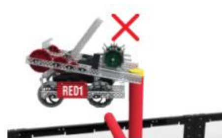
图 10 该机器人不视为提升，因为它接触了提升杆盖
