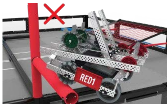
图 9 该机器人不视为提升，因为接触了护栏
