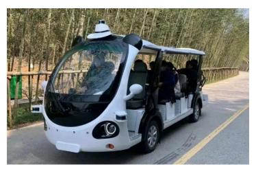
无人驾驶观光车内置高精度定位传感器和地图导航系统,可以实现自主导航和路径规划,能够识别交通信号灯、交通标识,不需要人工干预。无人驾驶观光车采用人机交互界面,乘客可以通过触摸屏幕或语音命令与车辆进行交互,获取相关的旅游信息和景点介绍。无人驾驶观光车配备了多种安全装置,如红外线传感器、超声波雷达等,可以实时监测周围环境,避免与障碍物碰撞。无人驾驶观光车采用电力驱动系统,不会产生尾气和噪音污染,符合环保要求。
