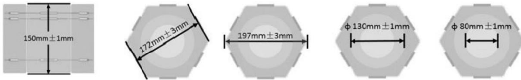
图 3.7 容器高度、对边距、对角线长及上层板开孔直径
