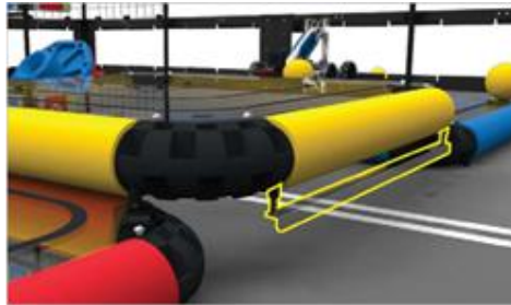
图5 中央泊位侧面加亮的聚碳酸酯结构用于防止小球进入，不用于停泊
